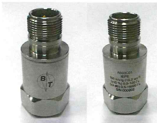
Рисунок 1 – Общий вид акселерометров моделей A603C01, A603C01T, A603C01E
